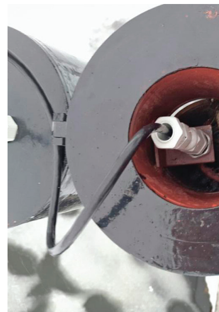
Рис. 7. Удаленная настройка логгера PROMODEM без выезда на объект: логгер сам заберет настройки при плановой передаче архивов измерений на сервер диспетчерской (или при внеочередной отправке аварийного архива)
